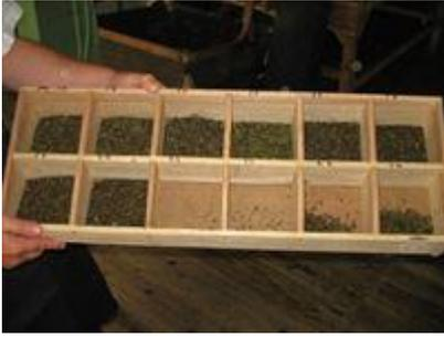
Der schwarze Tee, der den Trockner verlässt, ist der sogenannte Roh-Tee., der jetzt über eine Anzahl von mechanischen Rüttelsieben verschiedener Maschengrößen in die handelsüblichen Sortierungen ausgesiebt wird. Es handelt sich hierbei um die Bezeichnungen der handelsüblichen Blattgrößen. Grundsätzlich erhält man beim Sortieren, bedingt durch die Maschenweite der Siebe:
